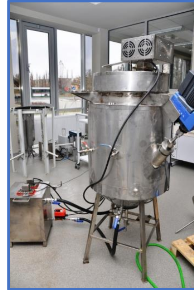
Reaktor z mikrofalowym systemem ogrzewania
