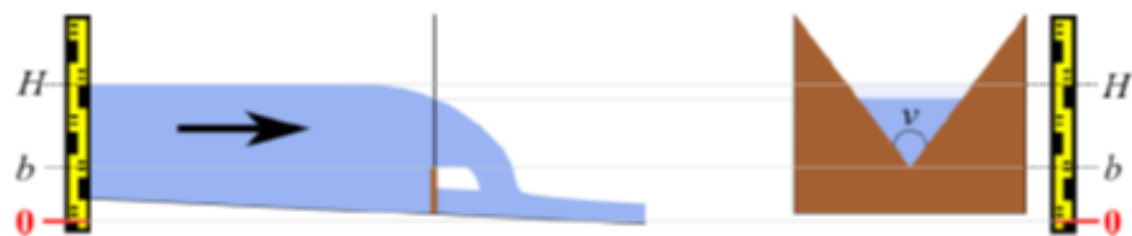
b) schemat przelewu trójkątnego z zaznaczeniem wartości mierzonych
