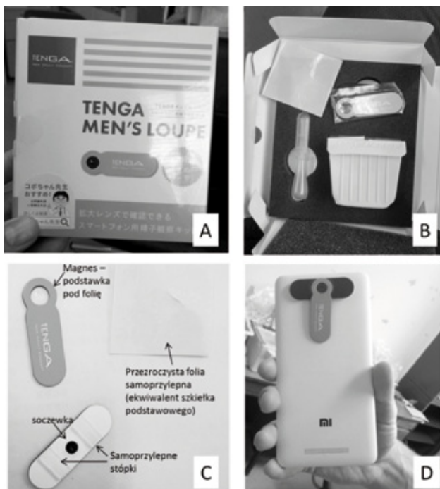
Rys. 1. Jednosoczewkowy mikroskop Tenga Men's Loupe. W opakowaniu znajduje się pojemnik na próbkę nasienia oraz pipeta do jego nakrapiania [B]. Mikroskop składa się z soczewki wbudowanej w podstawkę z samoprzylepnymi stópkami oraz podstawkę pod samoprzylepne folie pełniące rolę szkiełek podstawowych [C].
