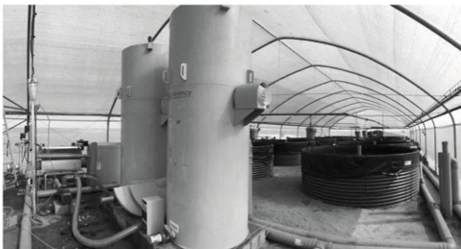
Ryc. 8 Kolumny filtracyjne typu all-in-one na farmie suma afrykańskiego Źródło: http://www.biofishency.com/projects
