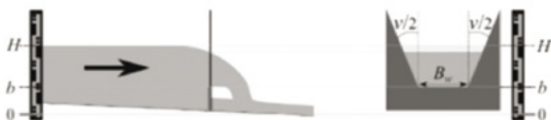
c) schemat przelewu trapezowego z zaznaczeniem wartości mierzonych
