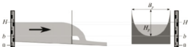
d) schemat przelewu kołowego z zaznaczeniem wartości mierzonych
