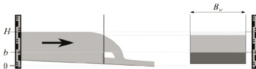
a) schemat przelewu prostokątnego z zaznaczeniem wartości mierzonych
